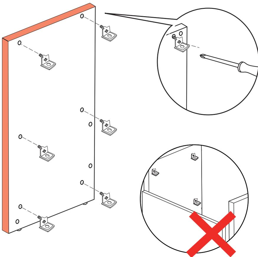
Si le fond encastré est placé derrière les tablettes installer d'abord le fond et ensuite mettre les supports de tablettes, refends et d'autres accessoires.
