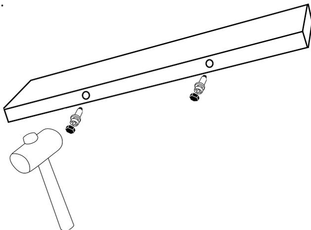
Insérer les boîtiers métalliques dans le bandeau de socle/raidisseur.
